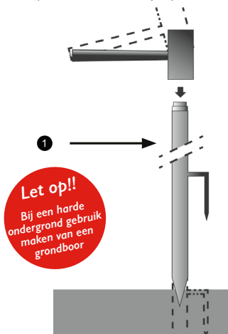
Figuur 2: Sla de grondbuis, na plaatsing van de slagpen, stevig in de grond. (met Anti-rotatie pin)
